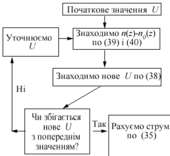
Рис. 15. Самоузгоджена процедура обчислення потенціалу провідника U і струму в розширеній моделі провідника.
