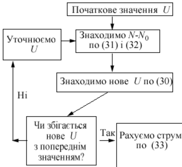
Рис. 12. Самоузгоджена процедура обчислення потенціалу провідника U і струму в точковій моделі провідника.
