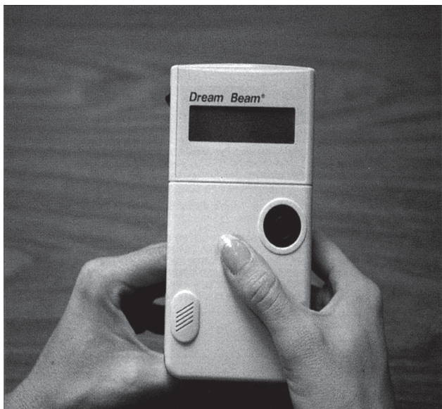
Рис.4. Внешний вид прибора “Dream Beam” для неинвазивного измерения сахара крови, разработанного фирмой Futrex и представленного на официальные испытания в 1995 г.
