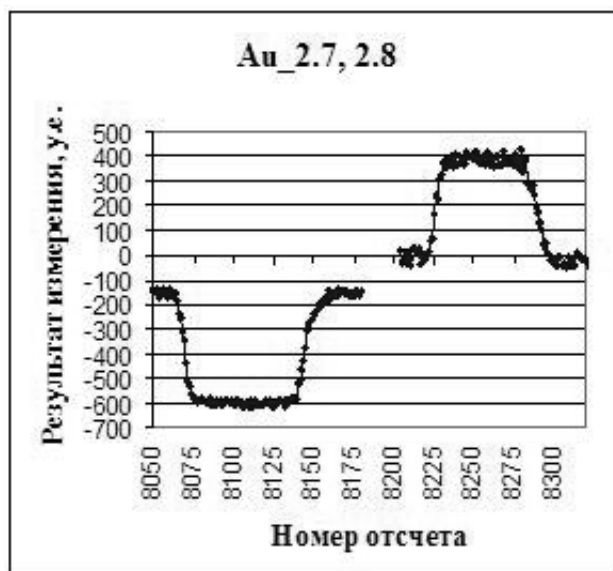
Рис. 11. Парные отклики измерительной системы при дифференциальных измерениях изменений разницы концентраций двух растворов
