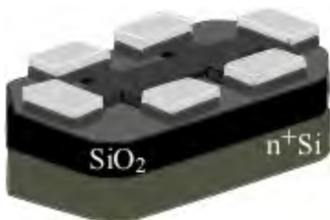
Рис. 5. Реальний польовий транзистор з графеновим каналом на підкладці \text{SiO}_2 , поміщений на електричний затвор – сильно легований кремній.
