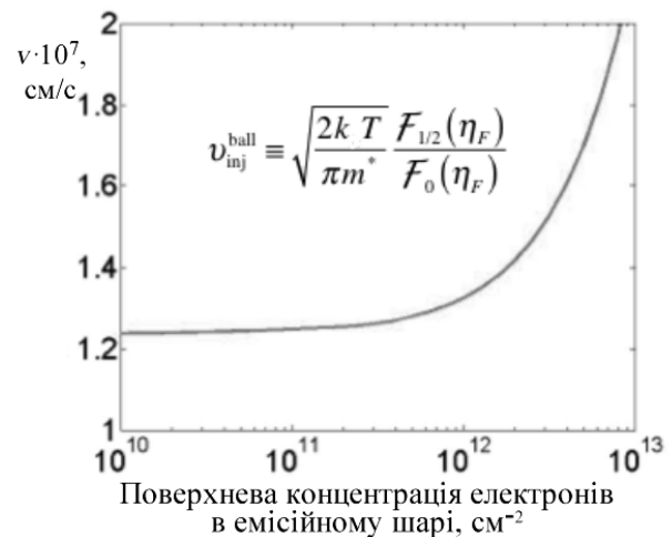
Рис. 4. Балістична швидкість впорскування v_{inj}^{ball} у залежності від поверхневої концентрації 2D електронів при T = 300 K у DG SOI MOSFET. Вважалося, що зайнята тільки нижня підзона провідності, де ефективна маса m^* = 0.19 m_0 і долинне виродження g_v = 2 [7]
