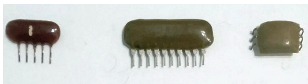
Рис. 3. Пристрої на ПАХ корпусовані компаундом.
